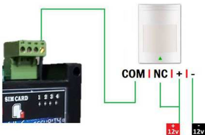
نحوه اتصال چشمی Paradox به ورودی ۴ دستگاه چهار کانال
